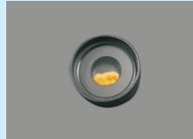
昂贵的稀有粉末状样品可以使用粉末测试盒(可选配件)进行测量。
