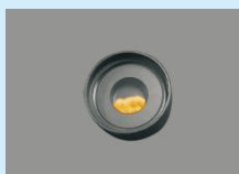
昂贵的稀有粉末状样品可以使用粉末测试盒(可选配件)进行测试。
